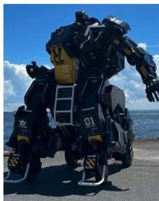
Archax, pesa 3,5 tonnellate ed è alto quattro metri e mezzo. Archax, come ogni robottone giapponese che si rispetti, ha una sua cabina di pilotaggio (senza aperture). Il robot si guida con due joystick, due pedali e un touchscreen con quattro display che mostrano l'esterno. Se acquisterete il robot, avrete anche accesso a corsi di pilotaggio del robot, onde non andare a sbattere o cadere in mare.
